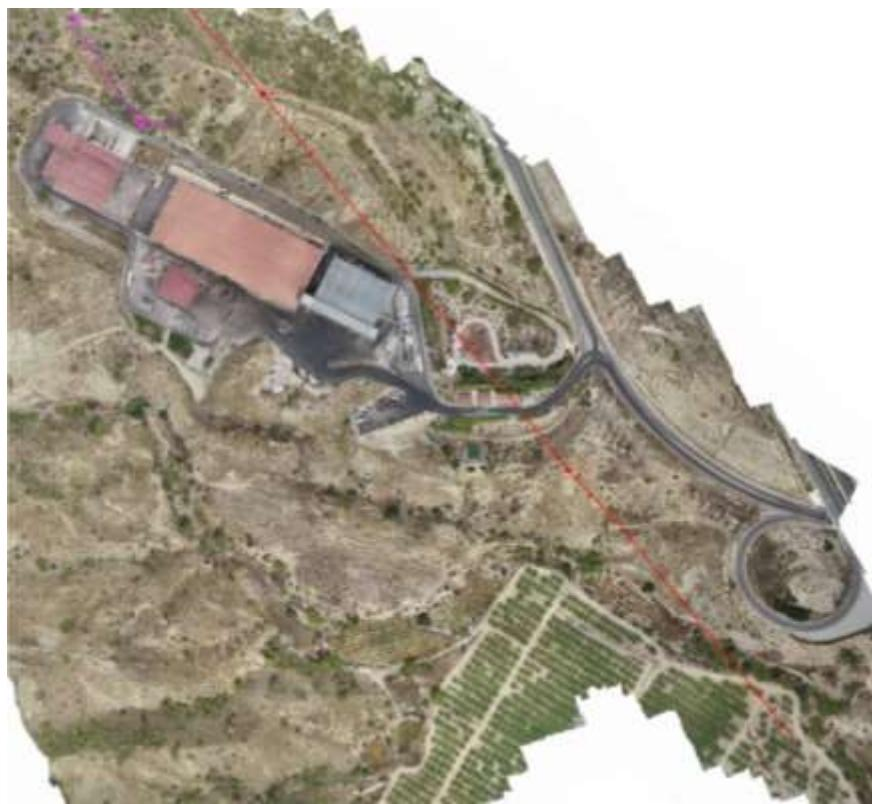
FIGURA 37. LÍNEAS ELÉCTRICAS RELACIONADAS CON LA PLANTA DE RESIDUOS YA EXISTENTE.
