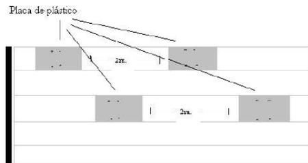
Figura 1: Esquema de la señalización de un vallado
